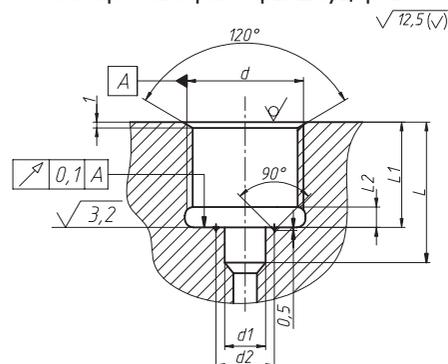
Габаритные размеры монтажных гнезд
