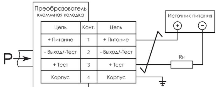
Рисунок 2 — Схема подключения преобразователей внешним кабелем
