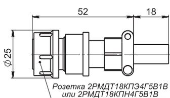
Ответная часть для разъемов 1394324-2 "TE" и СЦБ-4В Ф5.3723.008
