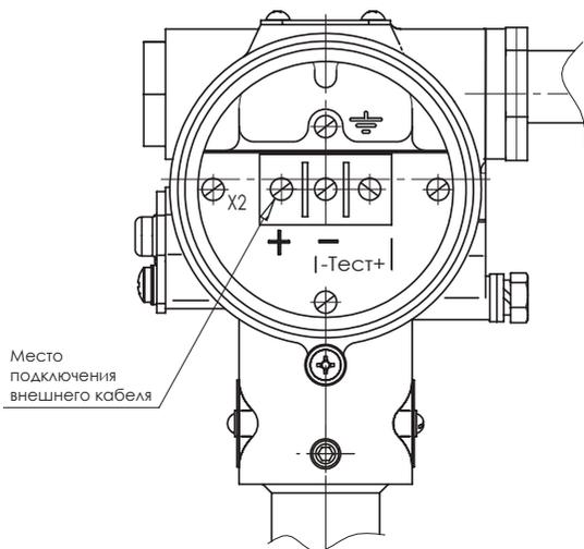
Рисунок 1 — Схема подключения преобразователей внешним кабелем
