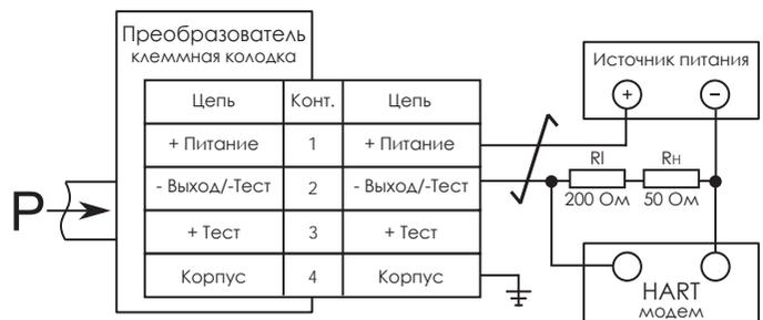
Рисунок 4 — Схема подключения HART модема к преобразователям
