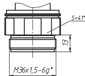
Габаритные размеры штуцера преобразователей с кодом присоединительной части «А»
