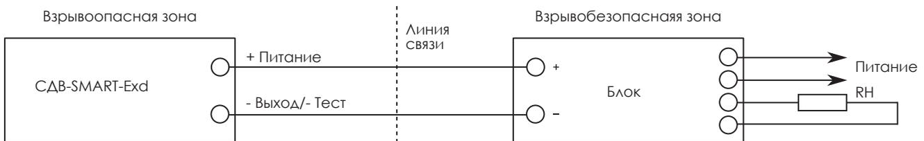
Рисунок 5 — Схема внешних электрических соединений преобразователей давления СДВ-SMART-Exd
