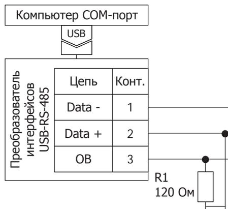
**Схема подключения преобразователя СП3301 к ПЭВМ, датчику давления СДВ и источнику электропитания.**
