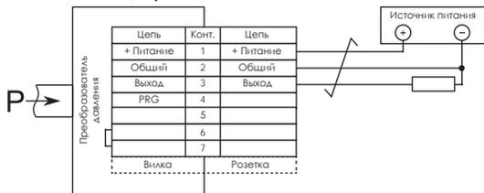
Схема подключения преобразователей с разъемом 2RMdT 1857Ш1В1В, контакты 6 и 7 вилки соединены перемычкой
