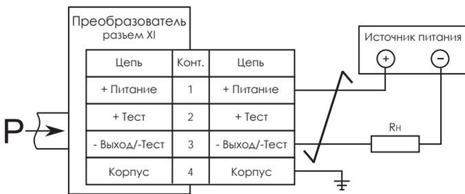
Рисунок 3 — Схема подключения преобразователей с выходным разъемом
